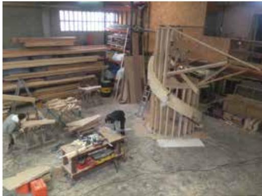
7. Una vez desencofrado, aprovechamos el tener la zanca en su posición para marcar unos puntos de referencia desde el trazado al suelo
